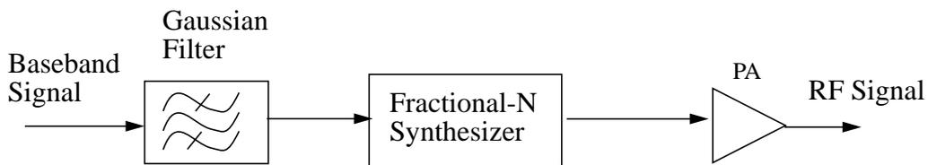
**Fig. 3.7** Direct-Modulation Transmitter
