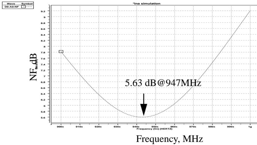
Fig. 5.13 NF of the LNA
